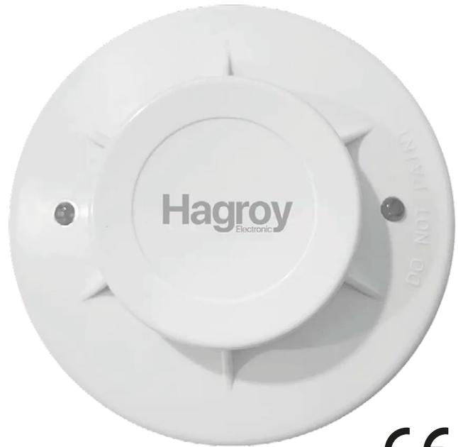
El HG-SD4/2 es un detector de humo convencional diseñado para brindar una detección confiable y eficiente en sistemas de seguridad contra incendios. Su diseño compacto y fabricado en ABS lo hace resistente y duradero. Funciona con alimentación de 10 a 33 VDC y puede conectarse mediante 2 o 4 hilos, lo que permite adaptarse a diversas configuraciones de seguridad. Además, cuenta con un indicador LED que facilita la identificación del estado del dispositivo.
